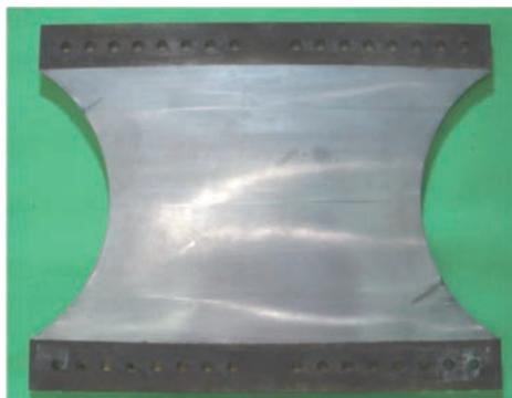
図17 加力終了後の FMS 合金心材の写真
