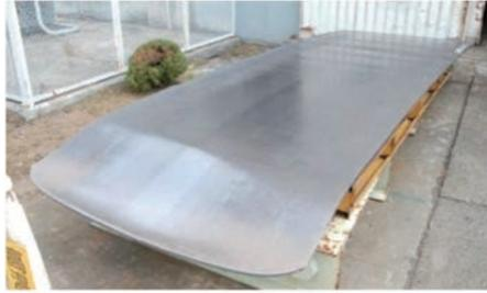
図7 ダンパー用大型圧延材
