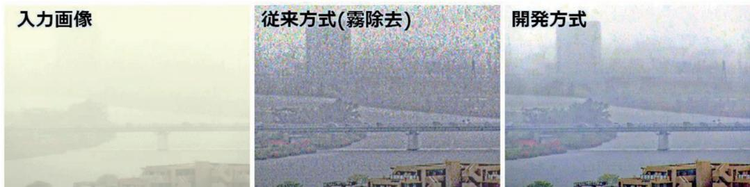
図5 開発方式の効果(ノイズの過強調抑制)
