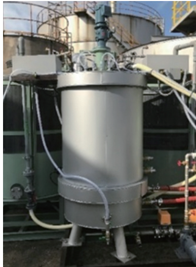
図8 連続回分式リアクター(液量：600L)
