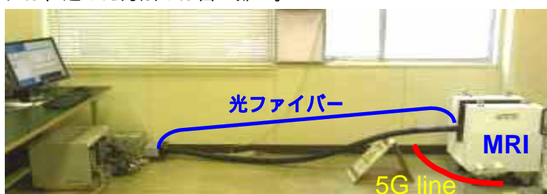
図 6 . 実験室レベルで試行されている光ファイバーを用いた MRI-PET の例
