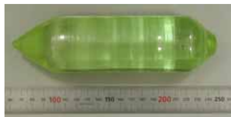
図4 . CZ法にて育成した 2インチ Pr:LuAG単結晶
