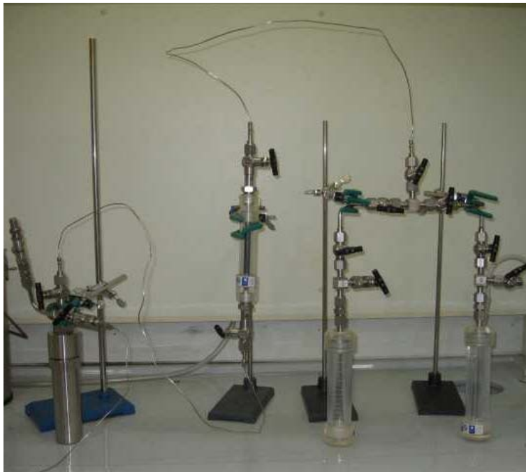
写真5 PCB汚染底質・常温脱水浄化試験装置 (左) DME供給槽・(中央) PCB汚染底質充填カラム・ (右) PCB抽出液採取容器(2つ)
