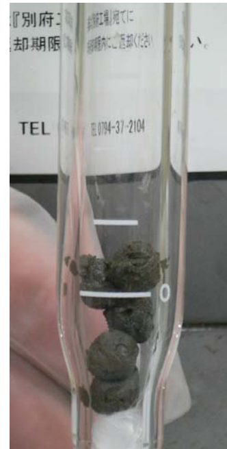
写真6 PCB汚染底質充填カラム拡大写真
