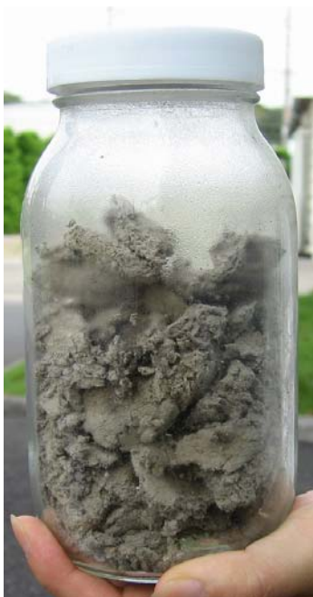
写真 3 DME 脱水後の下水汚泥 9)
