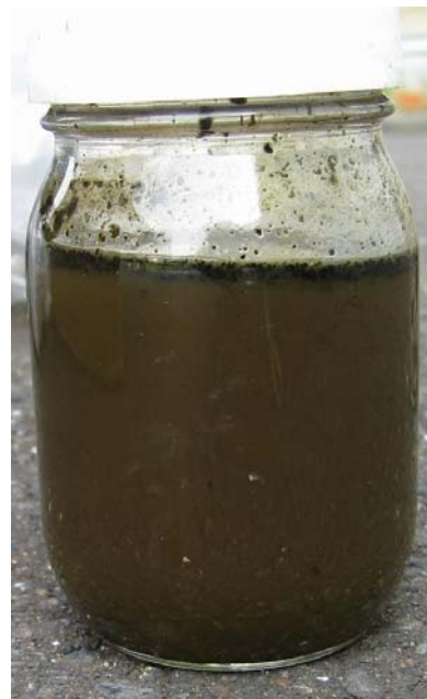
写真 4 DME 脱水処理で生じた排水 9)
