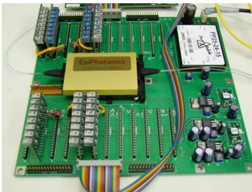
図 7 開発した PLZT 導波路光スイッチングサブシステム
