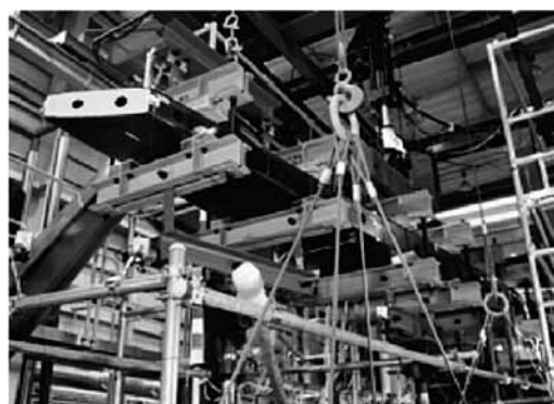
図16. 尾翼強度試験 [8]
