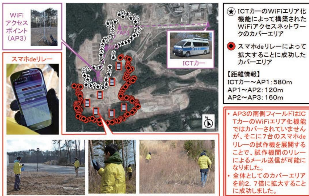
図8 ICTカーとの接続実験の概要
